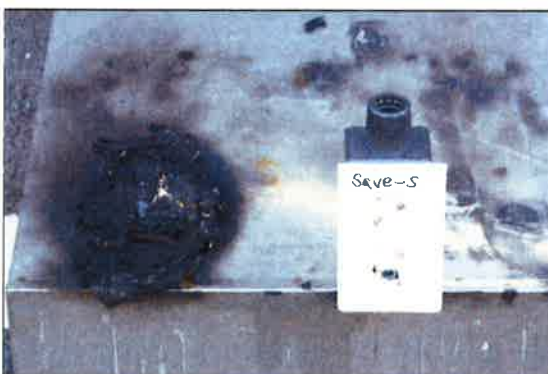
[사진 B.5] 시험 후(좌측 일반 콘센트 전소)
