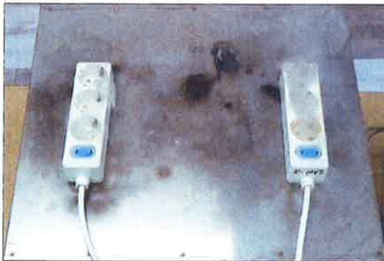
[사진 D.3] 시험 중 연기발생
