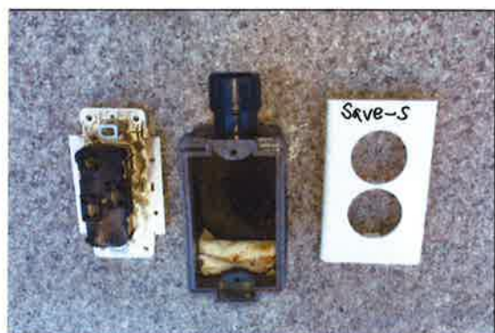
[사진 B.6] 시험 후(Save-S 자동소화 콘센트)
