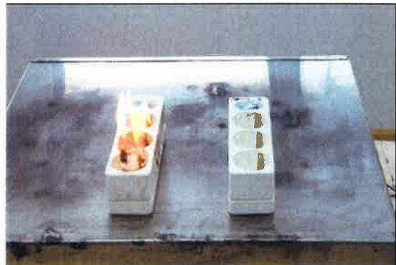
[사진 C.4] 시험 중 화재(좌측 일반 콘센트)
