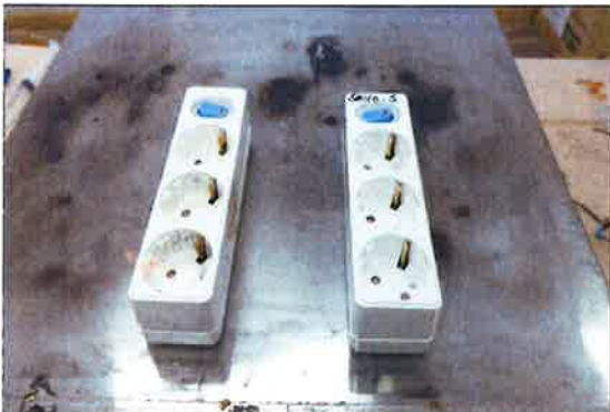
[사진 C.3] 시험체 조립(좌측-화염, 우측-소화)
