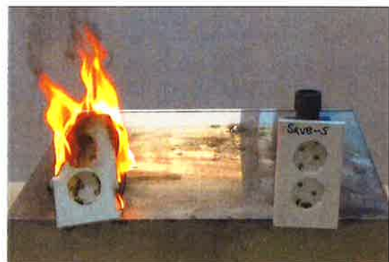
[사진 B.4] 시험 중 화재(좌측 일반 콘센트)
