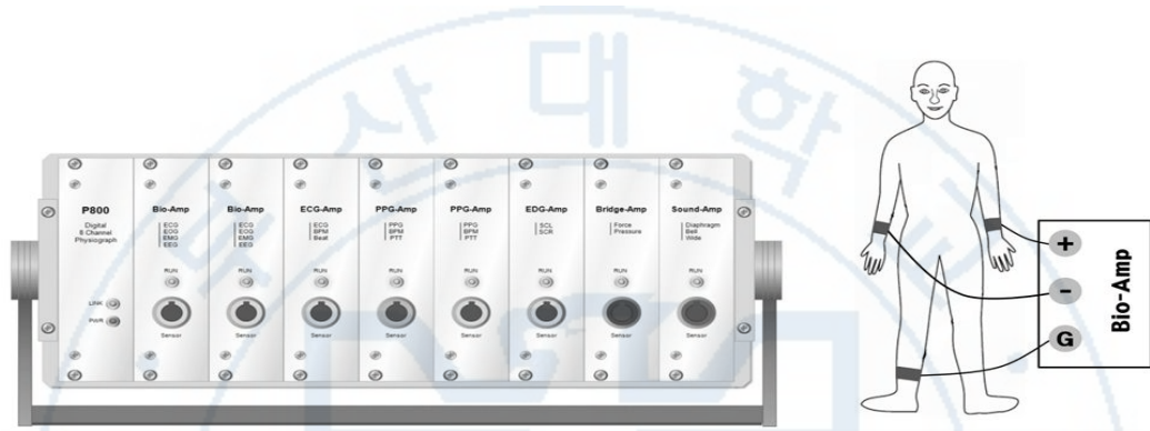
그림 14. 심전도 신호 측정 장비 및 전극 부착 위치
